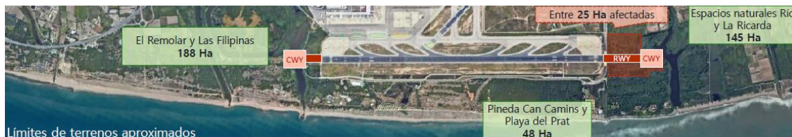
Figura 33. Opció d'allargament de la pista curta 300 metres. 200 metres a l'Est i 100 metres a l'Oest. Font: Joan Rojas
